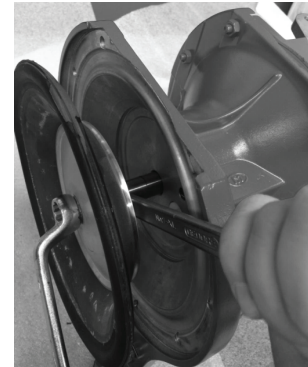
Bild 5: Kontern mit Maulschlüssel
